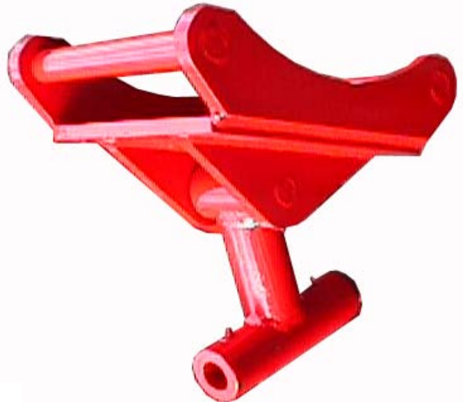
BAD ledad infäsrning mellan maskin och bormotor
